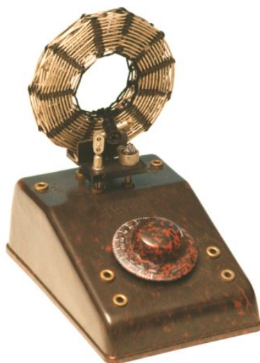
FIG. 6.2 – Cadre permettant de trouver la direction d'un signal radio (radiogoniométrie) en détectant sa composante magnétique
