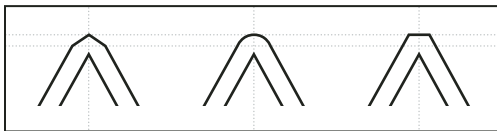
Exemples de sommets de recouvrement, de gauche à droite : en pointe, en arrondi, en biseau
