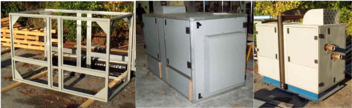
**Figure** - Structure typique d'un encoffrement : carcasse support, panneaux avec trappes de visite, encoffrement monté sur socle avec ouvertures pour passages et aération.
