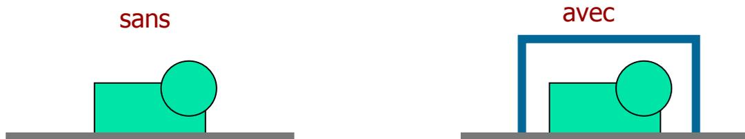
Les parois de l'encoffrement constituent une barrière au bruit aérien rayonné par la source, mais il ne faut pas oublier que c'est **l'ensemble des chemins de transmission** qui doit être maîtrisé afin d'optimiser les performances :
